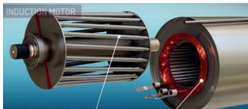
**1-rasm. Tesla S modelining statori va rotori.**
