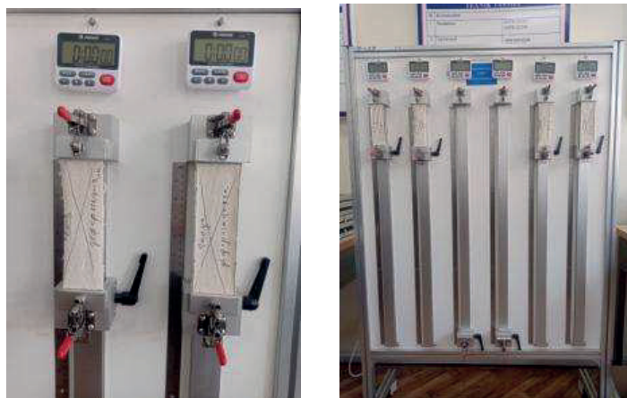
Рис. 3. Определение деформации на релаксметре
